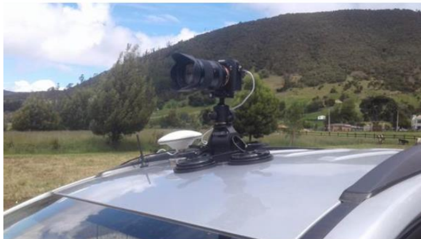
Ilustración 41. Componente de la tecnología “Sistema de Evaluación Vial de alto desempeño y bajo costo” Fuente: Centro de Investigaciones y Desarrollo Científico CIDC. Fotografía tomada por el Docente Wilmar Fernández
